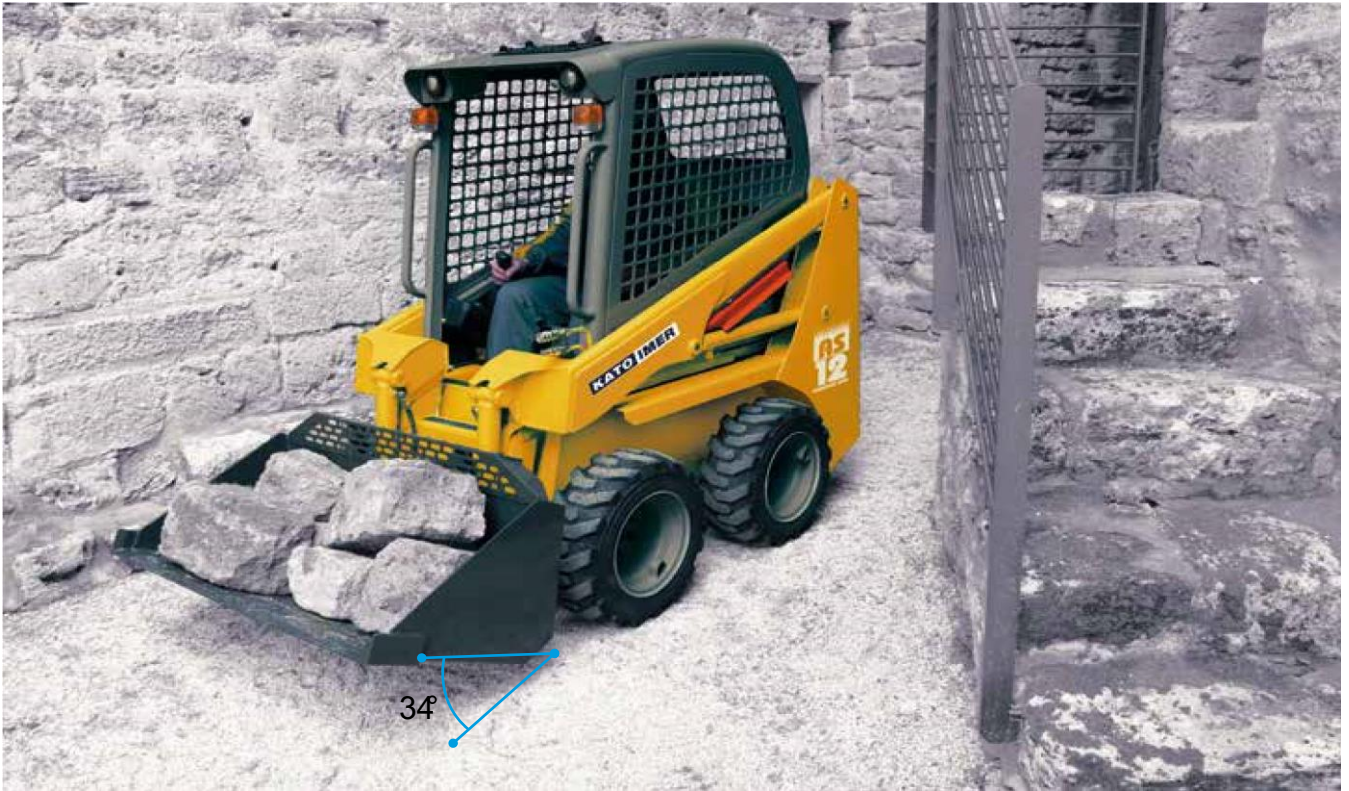
A nagyobb kanál szöggel elkerülhető az anyagpazarlás a szállítás során
